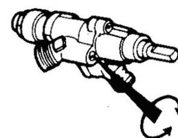
**N.B. : pour les réglages du gaz liquide, le brûleur doit être réglé au minimum en serrant complètement les dérivations du robinet.**
