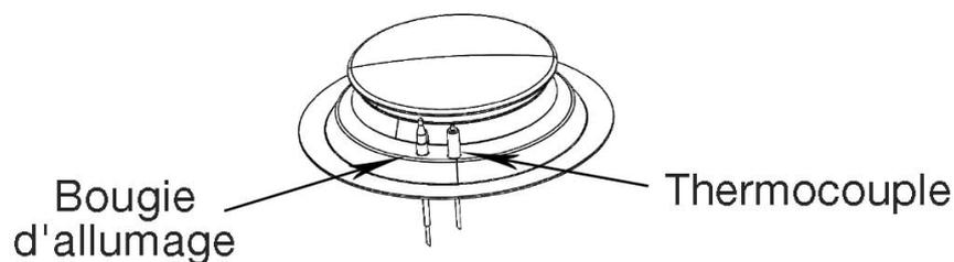
Tournez le bouton et introduisez une flamme dans le brûleur souhaité. En cas d'extinction accidentelle de la flamme, il est conseillé de tourner le bouton en position d'arrêt.
